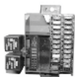
Блок предохранителей в салоне
